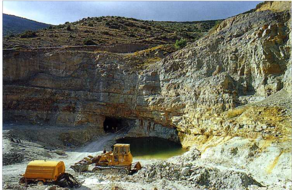
Otra perspectiva de las labores del primer nivel. Se ha comenzado un avance por el que se pretende establecer una red de cámaras y pilares. A techo, el paquete de calizas. Foto: Francisco Piña, Julio de 1.995.
