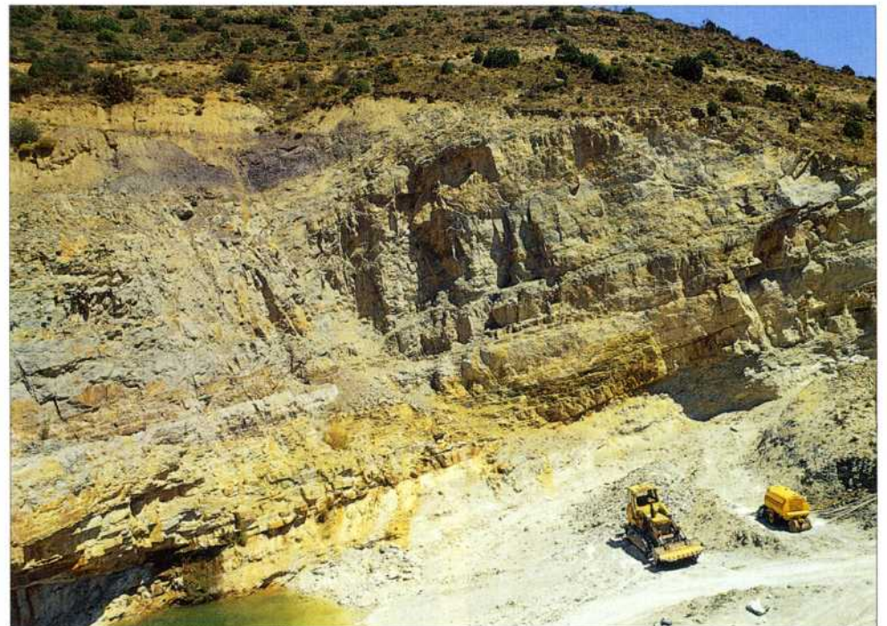
Perspectiva del primer nivel de margas. Se distingue con claridad el buzamiento de las capas contra la topografía. El piso de la cantera corresponde al muro de la primera capa mineralizada. Foto: Francisco Piña, Julio de 1.995.
